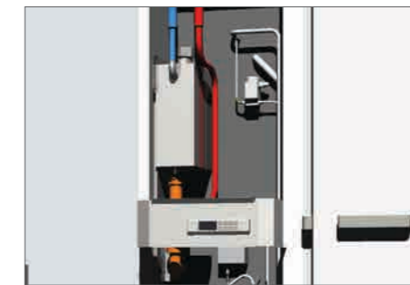
Porkka RHDS®-enheten är utrustad med en köldmedium-till-vätska-värmväxlare.
